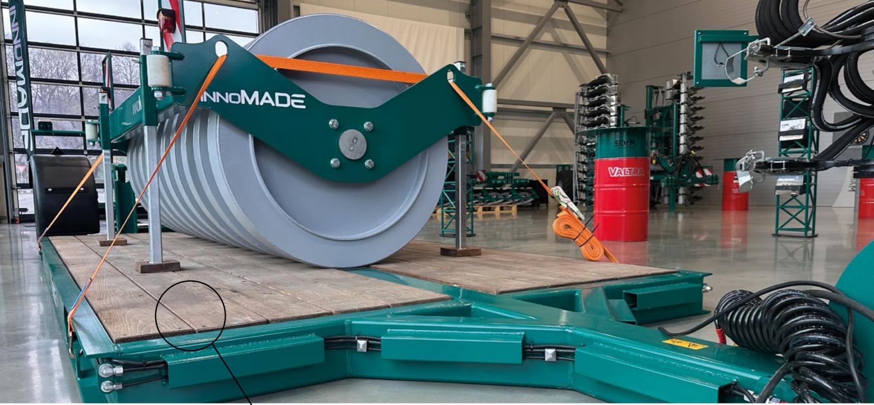
Die Ladefläche des **INNOMADE** Plattformwagens besteht aus 3 cm starken Massivholzbohlen und eignet sich für unterschiedlichste Transportgüter. Zur sicheren Fixierung der Ladung können im Lieferumfang enthaltene Zurrössen variabel an dafür vorgesehenen Vorrichtungen am Hauptrahmen angebracht werden.
