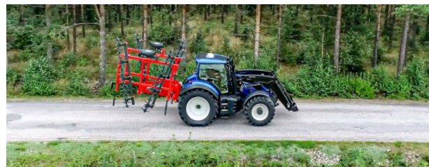
Die Transportposition der montierten Modelle ist kompakt.
