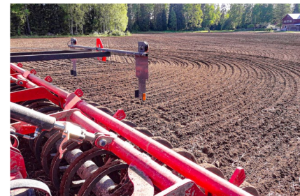
Der serienmäßige U-Profil-Doppelpacker stützt die Maschine über die gesamte Breite ab und erleichtert so die Steuerung der Arbeitstiefe unter verschiedenen Bedingungen.
