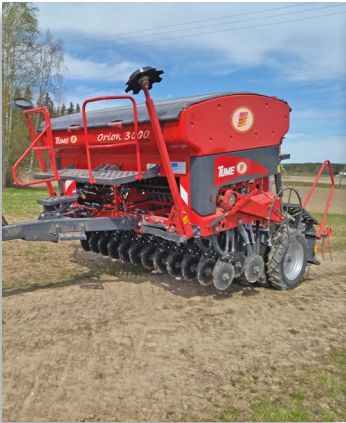
Der Saatbehälter von Orion verfügt standardmäßig über sichere und stabile Trittstufen, eine gefederte Abdeckplane, die sich auf beiden Seiten aufrollt, und Entleerungsventile an jeder Ecke des Behälters.
