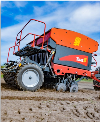
Der Saatbehälter von Orion verfügt standardmäßig über sichere und stabile Trittstufen, eine gefederte Abdeckplane, die sich auf beiden Seiten aufrollt, und Entleerungsventile an jeder Ecke des Behälters.
