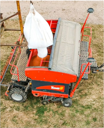
Der Saatbehälter von Orion verfügt standardmäßig über sichere und stabile Trittstufen, eine gefederte Abdeckplane, die sich auf beiden Seiten aufrollt, und Entleerungsventile an jeder Ecke des Behälters.
