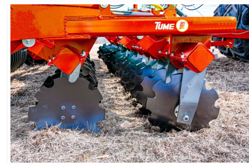
Die robuste Befestigung der Scheiben ist so konzipiert, dass sie auch unter felsigen Bedingungen standhalten.
