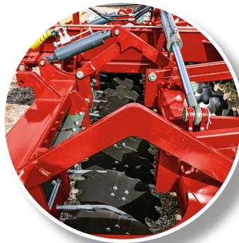
Die Arbeitstiefe der Maschine kann durch Drehen der Scheibenachsen hydraulisch präzise eingestellt werden.
