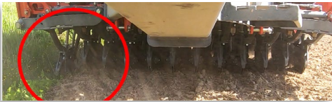
Abbildung 2. Die Stärke der Pflugscharen von Orion liegt in ihrer Geometrie und der ausgesprochen großen Bewegungsbahn sowohl nach oben als auch nach unten. Dies ermöglicht eine erfolgreiche Aussaat selbst nach einer reduzierten Saatbehandlung.
