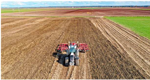
Die Egge der T-Serie bearbeitet den Boden bei Bedarf grob und bleibt auch beim Grubbern von härteren Stoppeeln gut offen.
