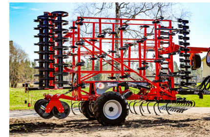
Der große Spurbestand und die hydraulische Federung der Transporträder ermöglichen einen stabilen Transport auf der Straße.
